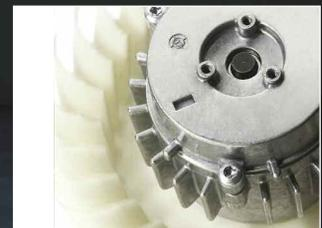
Moteur économique à haut rendement. Roulement à billes LongLife pour 40 000 h de fonctionnement en toutes positions. Sans entretien, dans un carter fermé en fonte d'aluminium.
