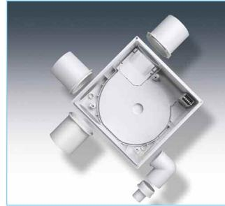
**Possibilités infinies.** Les modèles ELS-GU et -GUBA sont des boîtiers universels pour la ventilation d'une ou de deux pièces avec possibilité de branchement sur la gauche, la droite, en bas ou pour le raccordement de la cuvette des WC par la chasse d'eau. Le piquage de rejet peut être positionné en haut, à gauche, à droite ou à l'arrière. Et ce, avec un seul et même boîtier !
