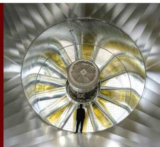
*Ventilateur axial, débit jusqu'à 150 000 m<sup>3</sup>/h et redresseur disposé en amont. Utilisation: simulateur aérodynamique en conditions proches de la réalité.*
