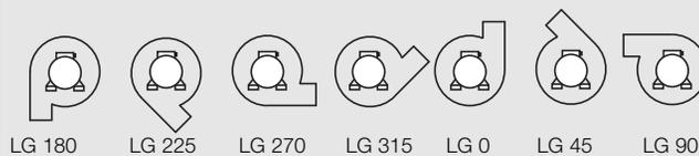
LG 180 LG 225 LG 270 LG 315 LG 0 LG 45 LG 90
