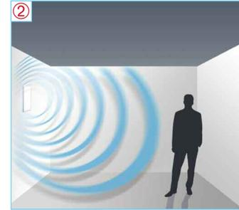
Le fonctionnement d'un système de ventilation doit rester discret, surtout dans les immeubles d'habitation. C'est désormais possible grâce à la gamme ELS Helios, dotée de la technologie ultraSilence®. Avec 26 dB(A)\* pour un fonctionnement en débit d'air permanent ( $V = 35 \text{ m}^3/\text{h}$ ) et 35 dB(A)\* pour  $V = 60 \text{ m}^3/\text{h}$  et  $A_L = 10 \text{ m}^2$ , difficile de faire plus silencieux!
