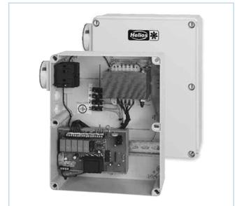
Possibilité de régler le décalage de vitesse entre ventilateur slave et master et de commander plusieurs ventilateurs triphasés slave dans la limite du courant max.
