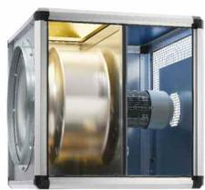
Le moteur placé hors du flux d'air est séparé de la turbine par une paroi isolée thermiquement. Le groupe moto-turbine est extractible sans démontage de la gaine.
