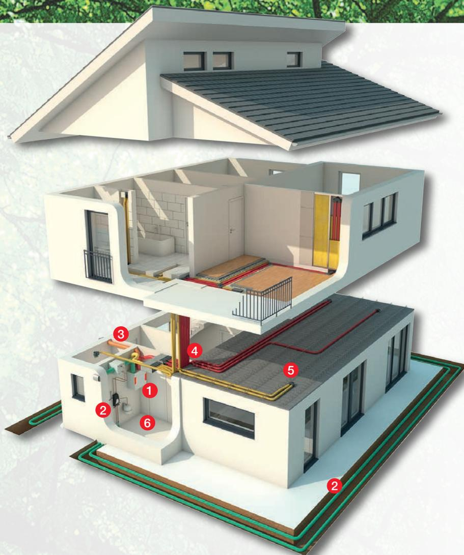
**1** Centrale de ventilation double flux à récupération d'énergie
