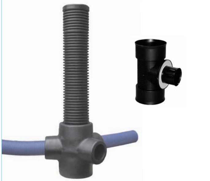
Helios propose un regard étanche en kit permettant une adaptation aux configurations du terrain. L'utilisation d'un regard étanche sur un réseau d'échangeur d'air géothermique (puits canadien) est indispensable lorsque par exemple le terrain est en contre-pente ou que le bâtiment n'a pas de sous-sol.
