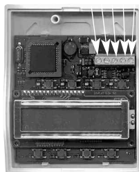
Vue interne de la commande à distance (fig. sans garantie)
