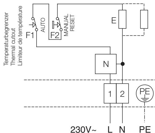
E - Heizungs Element / heating elements
