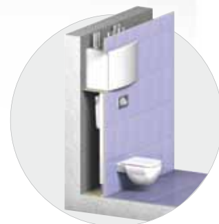
Installation en bâti-support
