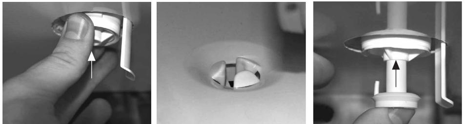
4. Syphon-Gehäuse aufstecken und mit 1/4 Drehung gegen den Uhrzeigersinn im Befestigungsteil einrasten (Darauf achten, dass die Schwimmer-Kugel im Gehäuse liegt!)
