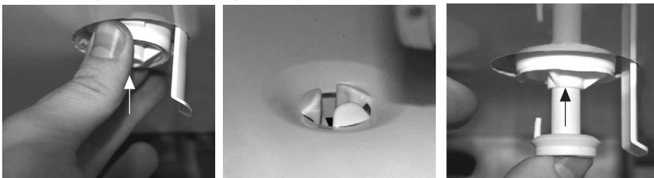
4. Monter le corps de siphon sur le disque de fixation et tourner 1/4 de tour en sens inverse des aiguilles d'une montre (vérifier la présence de la boule dans le corps!).
