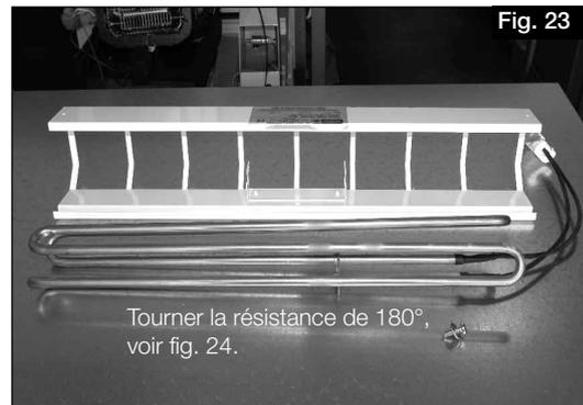
3. Retirer la résistance (fig. 21) et la tourner de 180°.
