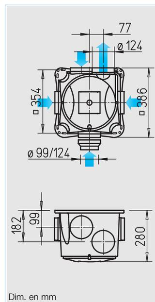
■ La technologie des moteurs à courant continu, appliquée au ZEB EC, permet de réaliser un groupe d'extraction contrôlée à basse consommation, indispensable pour l'utilisation dans les maisons BBC.
