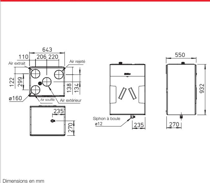
**Centrale compacte avec récupération de chaleur pour la ventilation centralisée de logements. Équipée du système Helios easyControls 3.0, le concept de régulation innovant qui facilite sa connexion au réseau et son utilisation via un navigateur. Disponible au choix avec un échangeur synthétique ou un échangeur enthalpique à haut rendement pour une récupération accrue de l'humidité. Dotée de moteurs EC à haut rendement énergétique.**
