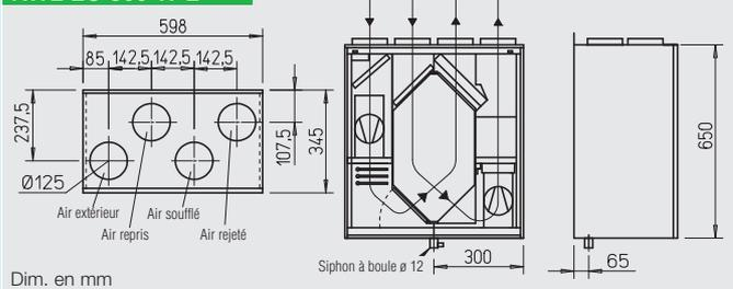
**Groupe double flux compact à récupération d'énergie pour la ventilation centralisée des appartements et maisons individuelles. Testé selon EN 13141-7. Doté de la nouvelle régulation innovatrice Helios easyControls, pour le pilotage par serveur Web via un réseau local ou Internet. Équipé au choix, d'un échangeur à haute efficacité en Alu/PE ou enthalpique pour la récupération de l'humidité. Moteurs EC à basse consommation d'énergie.**
