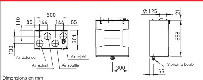
Centrale compacte avec récupération de chaleur pour la ventilation centralisée de logements. Équipée du système Helios easyControls 3.0, le concept de régulation innovant qui facilite sa connexion au réseau et son utilisation via un navigateur. Disponible au choix avec un échangeur synthétique ou un échangeur enthalpique à haut rendement pour une récupération accrue de l'humidité. Dotée de moteurs EC à haut rendement énergétique.
