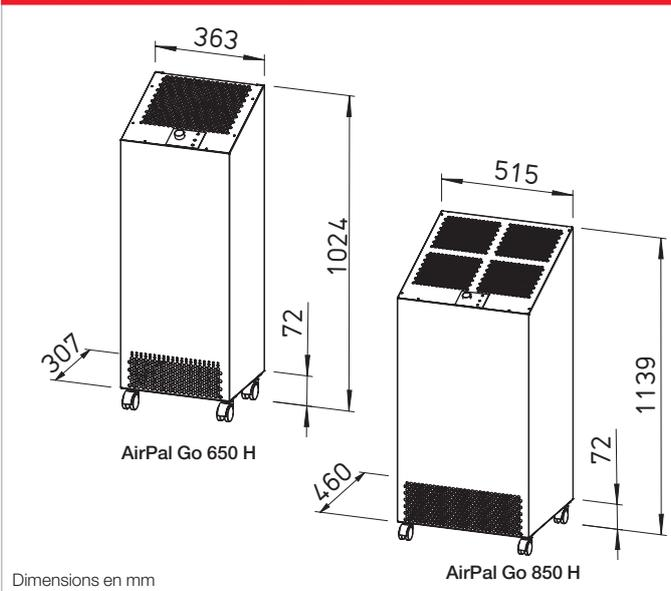
Appareil mobile, fonctionnant en recyclage et permettant de purifier l'air de pièces individuelles plus petites, jusqu'à env. 70 m<sup>2</sup>. Si les pièces sont plus grandes, vous avez la possibilité de combiner plusieurs appareils. Équipé d'un filtre à 2 niveaux (filtre HEPA 14 incl.), permettant d'éliminer 99,995 % de tous les virus présents dans l'air ambiant.
