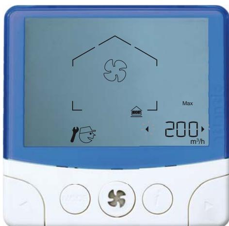
Utiliser les flèches de navigation ◀ et ▶ pour augmenter ou diminuer la valeur du débit souhaité lors de l'activation de la surventilation.
